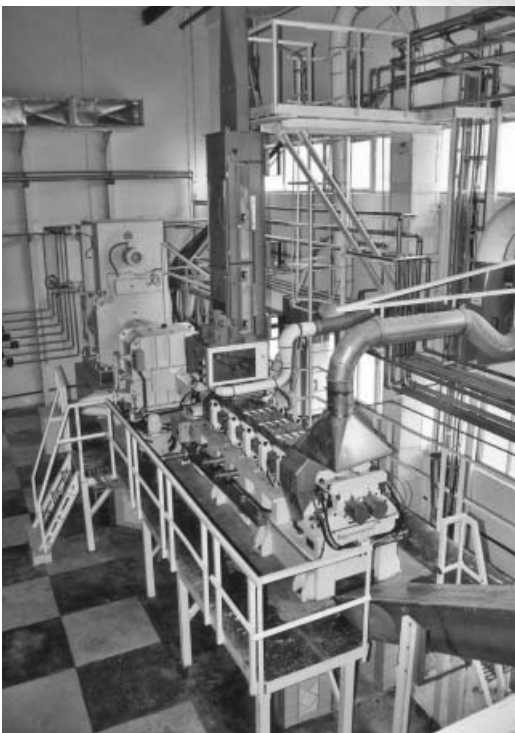
Bivis 1 : Précoupe des fibres, imprégnation soude
