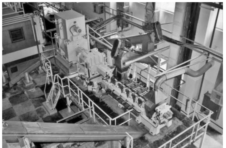
Bivis 2 : Coupe des fibres, lavage et blanchiment.
