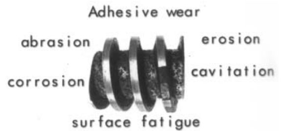
figure 2 : modes de dégradation dans l'extrudeuse bvis
